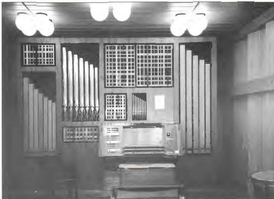
*Mechanische Spieltraktur, elektrische Registratur links der Manuale, drei freie Kombinationen, eine Pedalkombination. Normalkoppeln und Kombinationen als Wippen und Pistons in Wechselwirkung.*
